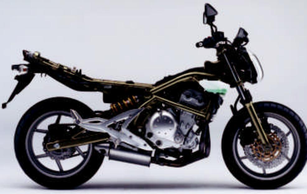
**Kawasaki ha optado** por un bicilíndrico en línea con inyección electrónica con toberas de 38 mm y refrigeración líquida. Cuenta con eje de equilibrado, ejes de cambio superpuestos y cambio tipo cassette extraíble, para reducir volumen total. Escape con salida bajo el motor, que incorpora un catalizador gracias al que se supera la Euro III.
