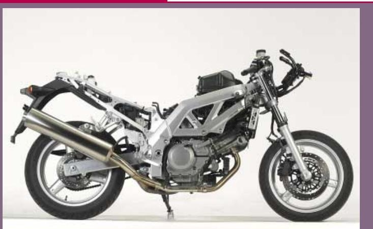
● Receta conocida y de éxito, cambia la parte ciclo con un chasis de parecida disposición al anterior pero variando los tubos de sección circular por otros llenos de aristas de aspecto mucho más actual. Buenos frenos y suspensiones efectivas, carenado cómodo y estéticamente agraciado, y un conjunto manillar, asiento y reposapiés que configuran una posición de conducción deportiva sin extremos.
