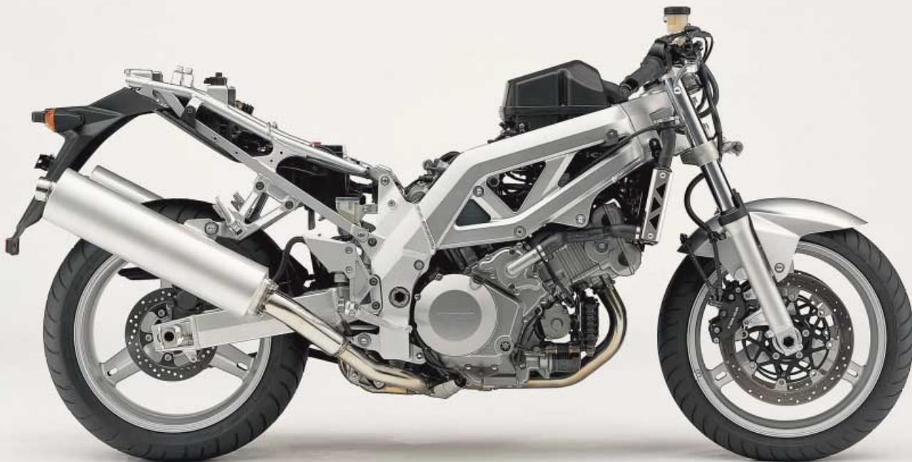
**N**o tiene por qué ser cara para ser depositaria de gran tecnología. En suspensiones y frenos, la SV «se limita» a tener material deportivo de plena actualidad. En el chasis se mezclan tres técnicas de fabricación, siempre en fundición de aluminio, mientras que el motor da mucho de que hablar, como aquí puedes ver.
