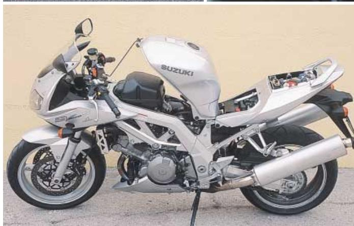
**Fácil lo tienes.** Hay poca carrocería que quitar, el depósito se articula para dejar paso al filtro y bajo el asiento principal están los componentes eléctricos. Ni siquiera tendrás que cambiar el pilotos de freno: son leds infundibles. El tablero es moderno, pero aparte del doble parcial y el reloj horario no hay más información destacable.
