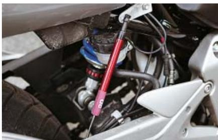
Sensor para el recorrido del basculante. Montamos un amortiguador regulable en longitud para ganar altura libre al suelo durante las pruebas.
