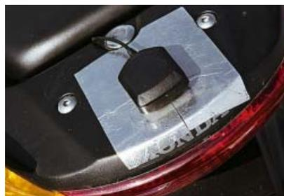
Antena GPS. Junto a la velocidad exacta y la trazada seguida, también transmite la inclinación en curva.
