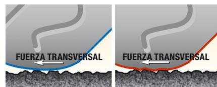
El punto de apoyo del neumático, la «huella», es la única zona de contacto de la moto con la carretera. En el dibujo se puede ver la que ofrece un 180 trasero deportivo (de perfil puntiagudo) a 48 grados de inclinación. El agarre lateral se genera en unos 38 cm<sup>2</sup> de superficie y además hay que tener en cuenta que sólo una pequeña parte de esta superficie está con contacto directo con el suelo en cada instante.
