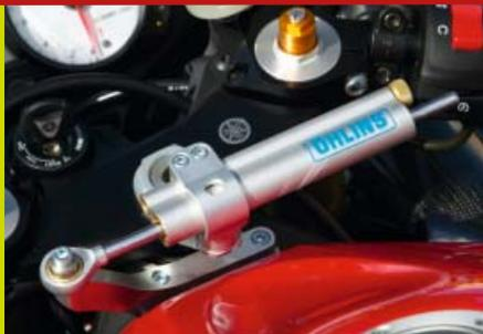
■ Un amortiguador de dirección puede perturbar el funcionamiento de la dirección. Engrasa sus articulaciones y aplica silicona en su eje para minimizar la fricción de los retenes.
