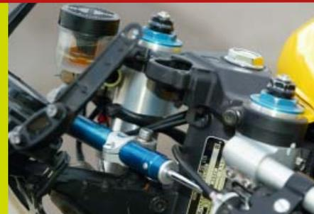
■ A veces el amortiguador de dirección está escondido: desmontar parte del carenado nos permitirá acceder también a los rodamientos de dirección y, de una sola vez, podremos
