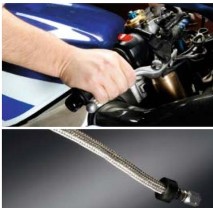
salida de ambas bombas tendremos en este ejemplo 30 bares, con pistones de 18 mm en la radial (lo que equivale a una superficie de pistón de 2'5 centímetros cuadrados) y de 16 mm en la tradicional (que son 2 cm cuadrados).
