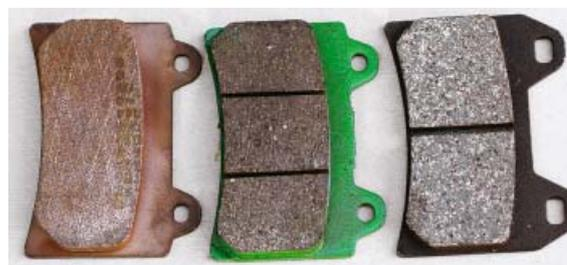
El compuesto de las pastillas es lo que determina la capacidad, la dosificabilidad y la resistencia al «fading» del sistema. El cambio de las pastillas por unas de mayor calidad que las de serie es una forma sencilla y barata de mejorar los frenos. Por cierto: la experiencia nos dice que tengan o no surcos no tiene ningún efecto...
