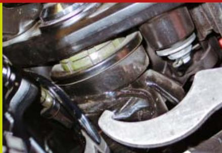
■ Los rodamientos de dirección son muchas veces culpables de la falta de precisión y estabilidad. Aflojarlos un poco puede ser un remedio temporal.
