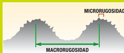
Las llamadas «microrugosidades» (rojo) pueden tener un tamaño de entre 0,001 y 0,1 milímetros y mejoran la adherencia en mojado, mientras que las «macrorugosidades» (verde) están entre 0,1 y 10 milímetros, y son determinantes especialmente con el asfalto en seco. Ahí es donde «muere» el neumático.
