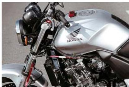
Sensores para la presión de frenada delante y detrás, para el movimiento de la dirección, la fuerza de giro y el recorrido de la suspensión delantera.
