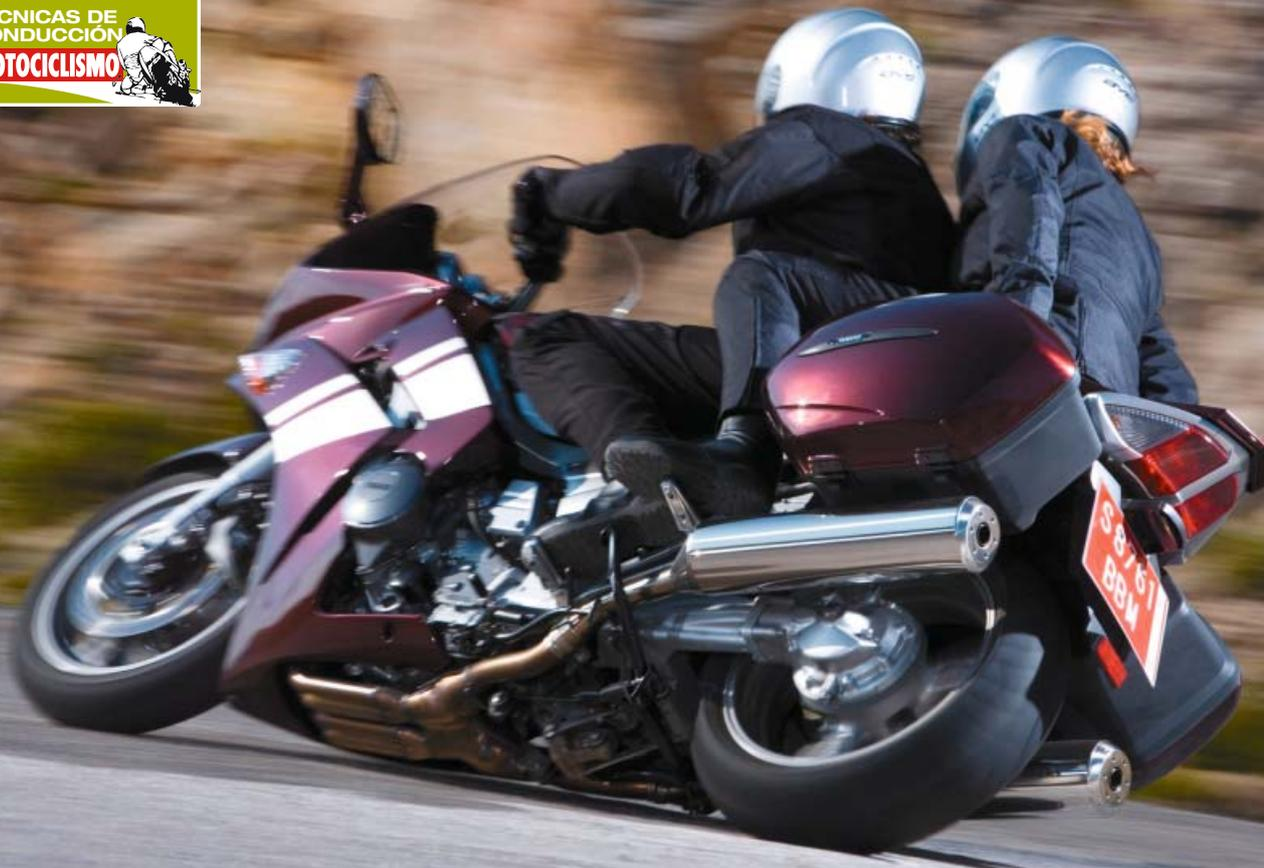
► **Al comprimirse las suspensiones, aún habiendo retocado las precargas, la distancia libre al suelo se reduce mucho y debemos extremar el cuidado en el paso por curva porque si toca algo «sólido», perderemos apoyo de los neumáticos**
