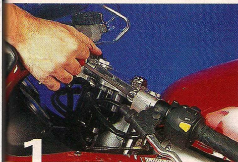
1 Aflojar tija. Antes de intentar quitar el tapón hay aflojar los semimanillares y la tija para que no lo bloqueen. En la foto, por claridad, aflojamos con el extremo de bola de la llave Allen, pero es mejor usar el terminal recto.
