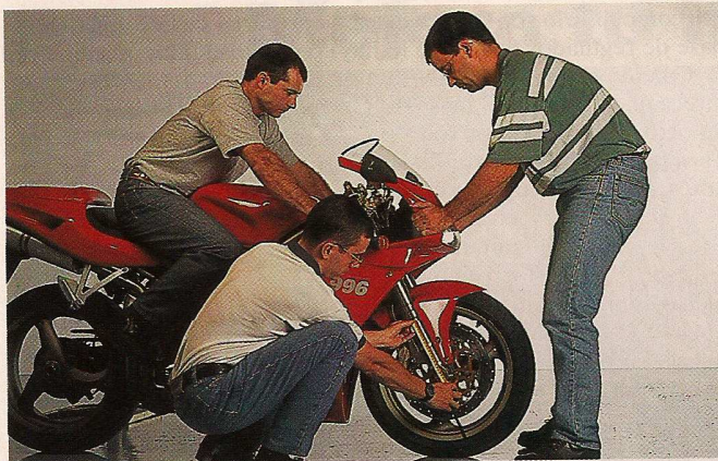
Medir el recorrido «muerto» de la horquilla con el piloto encima es el primer paso para saber si necesitas o no más precarga. Necesitas ayuda... aunque sólo sea un momento.
