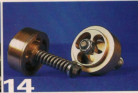
Válvulas de láminas. Estas válvulas hacen el mismo trabajo que en una moderna horquilla de cartucho. Modificando la precarga del muelle, a través del tornillo, regulas el reglaje de compresión. También puedes jugar con las láminas.
