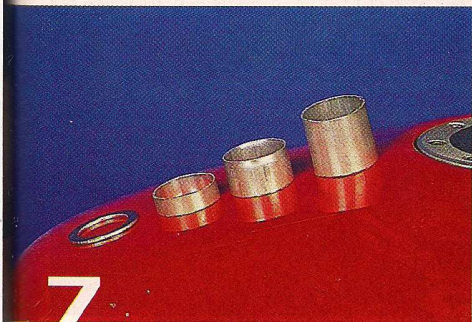
7 Casquillos de precarga. No olvides poner una arandela fuerte debajo del casquillo. Puestos a cortar tubo (lo puedes hacer a mano, con cuidado para que queden planos), lo mejor es hacerte un kit de suplementos de 1, 2 y 3 cm, no más.
