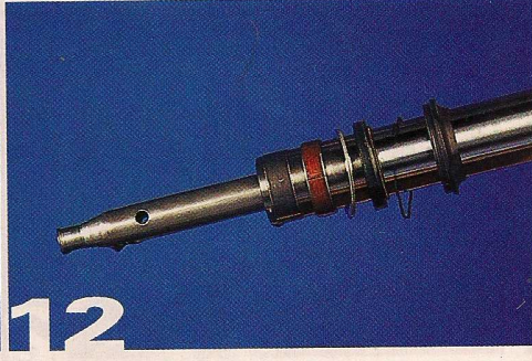
Interior de horquilla. En este caso no es imprescindible desmontar la horquilla para sacar el hidráulico, que ya sale por arriba. En cualquier caso conviene desmontarlo todo para limpiar el interior del todo que deja el aceite viejo.
